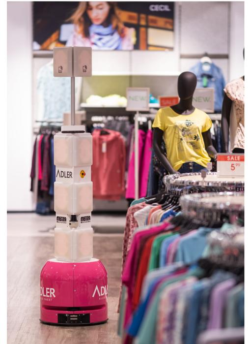
Auf seinem Weg scannt TORY die RFID-Tags an den Waren. Die Informationen werden gespeichert und können jederzeit abgerufen werden. TORY führt die Bestandserfassung per Knopfdruck oder zu einem vorgegebenen Zeitpunkt durch. Es ist kein manuelles Eingreifen notwendig. Der Einsatz ist daher sowohl tagsüber als auch nachts auf den Verkaufsflächen möglich. In wenigen Stunden erfasst TORY die Bestände mit einer Quote von mindestens 99%.
